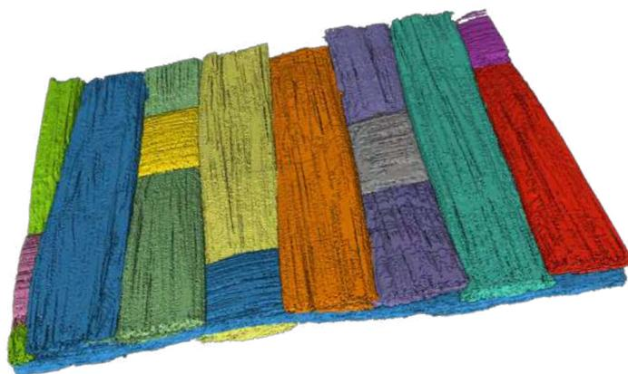
繊維複合材料の疲労により損傷が進む様子
